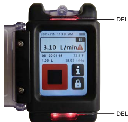
Figure 6. Rouge, clignotant : signale une défaillance de débit
