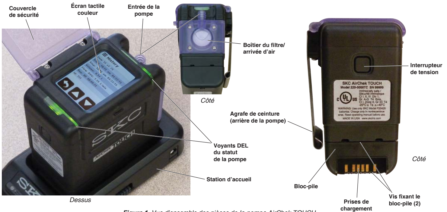
Figure 1. Vue d'ensemble des pièces de la pompe AirChek TOUCH
